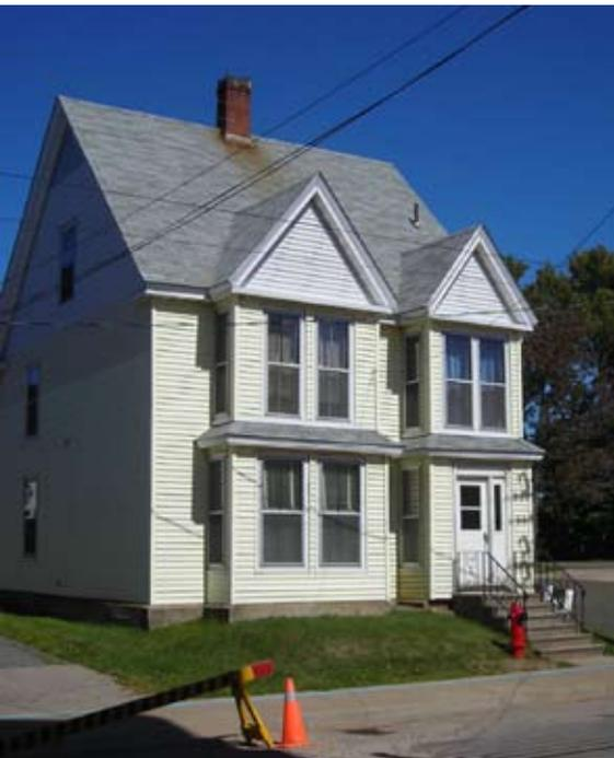
Ce bâtiment a perdu la plupart de ses détails de charpenterie lorsqu'il a été grossièrement recouvert d'aluminium il y a plusieurs années. Heureusement, l'aluminium s'est détérioré et s'affaisse. Plutôt que de le renouveler, un propriétaire éclairé et dévoué pourrait tenter de récupérer ce qui a été perdu.
