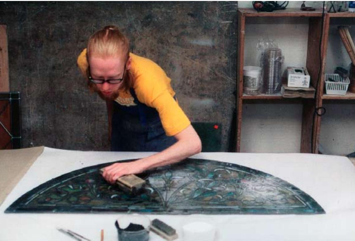
À l'étape du masticage ou cimentage, un coulis est injecté des deux côtés du panneau plombé pour assurer sa résistance et son étanchéité.
