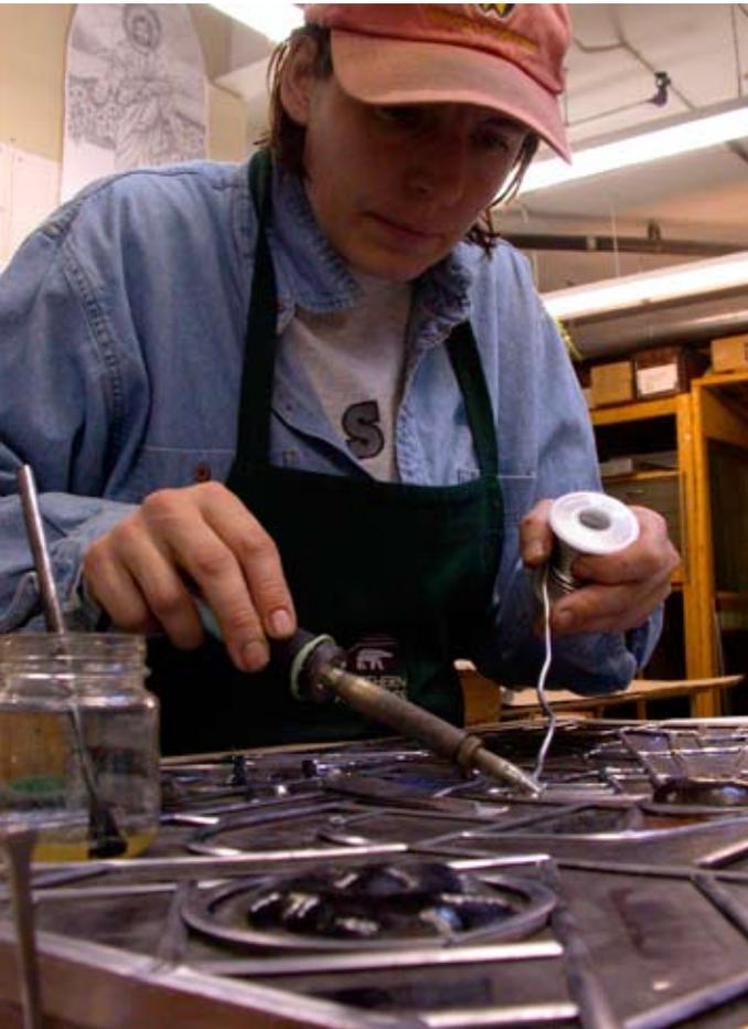
Un artisan de Northern Art Glass soude les verges de plomb aux joints en utilisant un flux organique et une brasure massive.
